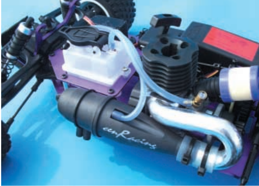
Der Flip-Flop-Tank fasst etwa 75 ccm, ausreichend für langen Fahrspaß
