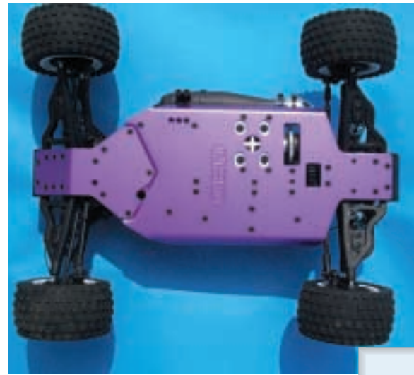
Der Krabblер auf dem Rücken, alle Schrauben sind vorbildlich im zweigeteilten Chassis versenkt
