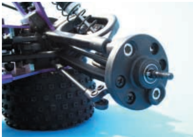
Die vordere Radaufhängung ist in Sturz und Spur voll einstellbar
