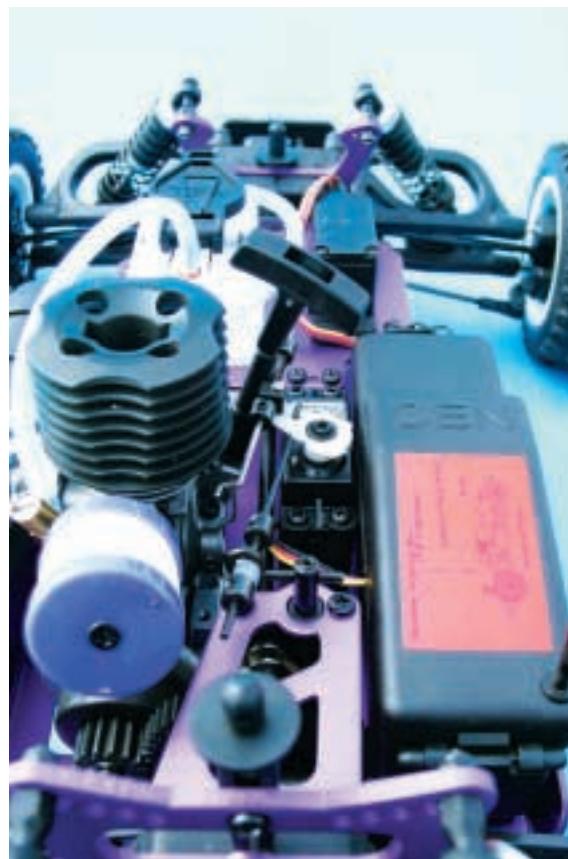
Blick auf das Gasgestänge – schon ab Werk gut eingestellt muss es nur in das Servohorn eingehängt werden
