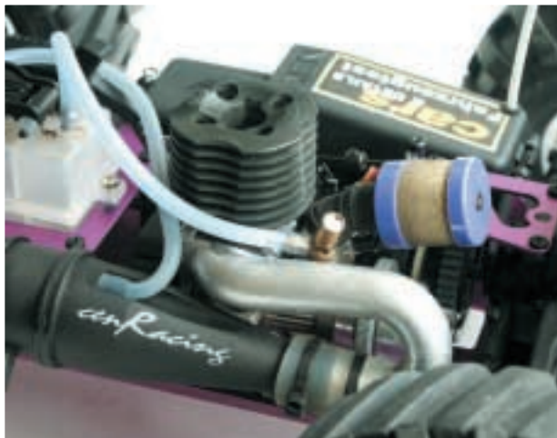
Das Kunststoffresorrohr mit Doppelrohrauslaß sorgt für einen angenehmen Sound des kräftigen CEN-Motors
