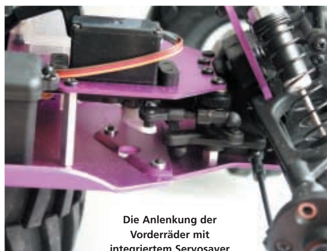
Dank des Pivot-Ball-Aufhängungssystem ist die Sturzeinstellung mit Hilfe eines Inbuss-Schlüssels ein Kinderspiel
