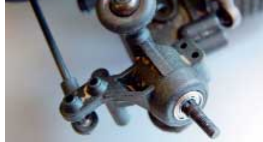
Beim Austausch der Lager sollte man keinesfalls mit Gewalt vorgehen, da die Achsträger beschädigt werden könnten
