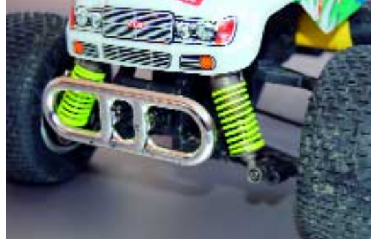
Wenn man im groben Gelände unterwegs ist, empfiehlt es sich, die Stoßdämpfer an den unteren Querlenkern am inneren Loch zu montieren, um die Bodenfreiheit zu erhöhen
